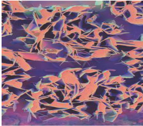
由 OP 技术制造的高密度 Bi-2212 丝状宏结构
